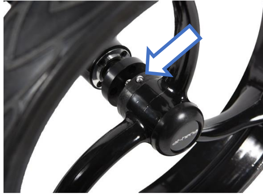
Illustration 2 : Roue et essieu avec petits boutons argentés
